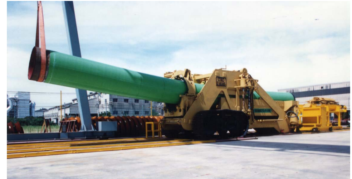
写真 1 φ762.0×19.0t (X65) 曲げ加工状況 (貝塚センター)
