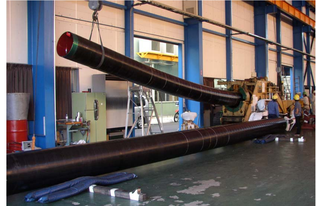
写真5 φ600A × 15.1t (X65) 曲げ加工状況(工場)
