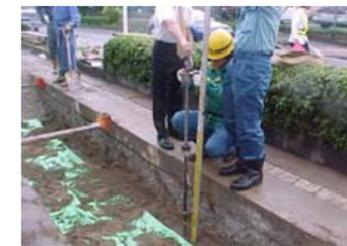
路床締固確認 (土研式貫入試験)
